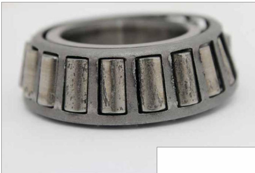
Abb. 9: Beispiel Lagerschaden durch Mangelschmierung
