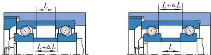
Fig. 13 Position preload
